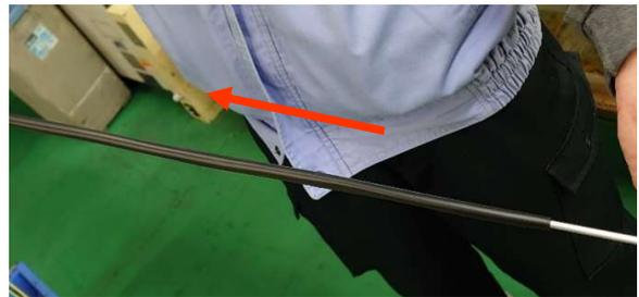
長いチューブが網チューブを通過するとき少し抵抗があるが、中の電線を掴みすぎないようにチューブを押し下げるとスムーズにチューブを通すことができる。
